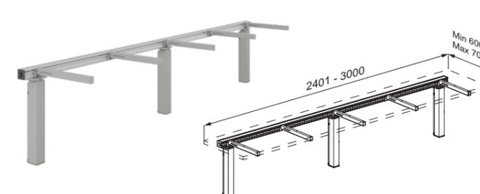
INDIVO Hubeinheit für Arbeitsplatte, mit drei Elektromotoren und Steuerkasten. Inkl. Querstrebe und fünf Träger. Höhenverstellbar bis zu 300 mm mit Zargeschalter oder kabelgebundener Fernbedienung. Für Arbeitsplatte in Länge 2401-3000 mm. Bitte Länge und Tiefe der Arbeitsplatte bei der Bestellung angeben. Ekskl. Befestigungsmaterial.
