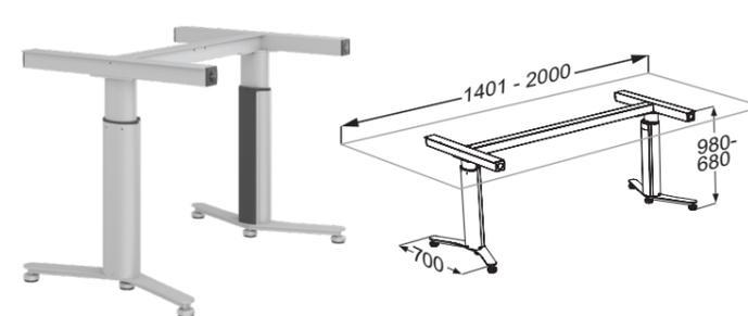
Elektrische Hubeinheit für freistehende Arbeitsplatte, Länge 1400 - 2000 mm. 300 mm höhenverstellbar. Inkl. 2 Teleskopbeinen, Längs- und Querprofile und Betätigungsschalter. Pressalit empfiehlt beidseitig 200 mm Platten überstand, um die Anfahrt im Rollstuhl zu erleichtern. Gewünschte Länge bei Auftragserteilung angeben.
