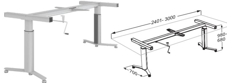
Manuelle Hubeinheit für freistehende Arbeitsplatte, Länge 2401 - 3000 mm. 300 mm höhenverstellbar. Inkl. 2 Teleskopbeinen, Träger, Längs- und Querprofile und Handkurbel. Pressalit empfiehlt beidseitig 400 mm Platten überstand, um die Anfahrt im Rollstuhl zu erleichtern. Gewünschte Länge bei Auftragserteilung angeben.
